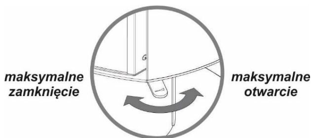
Rysunek 14. Ustawienie przycisku regulacji dopływu powietrza w pozycji maksymalnego otwarcia dla ogrzewacza CERES TOP
