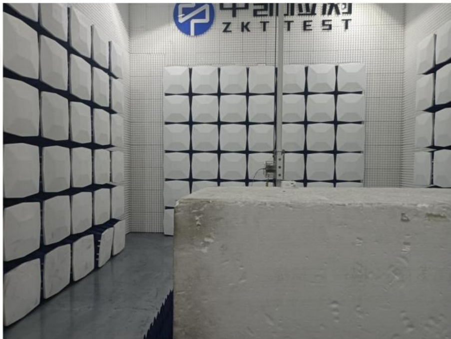
Konfiguracja testu emisji promieniowania 1 30 MHz – 1 GHz (Testy nadajników)
