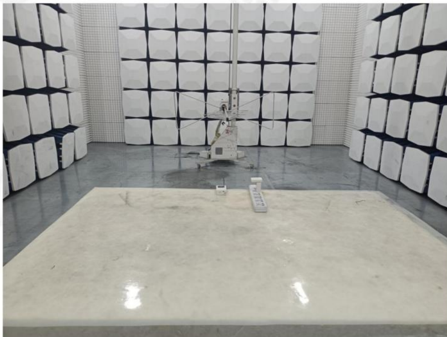
Konfiguracja testu emisji promieniowania
