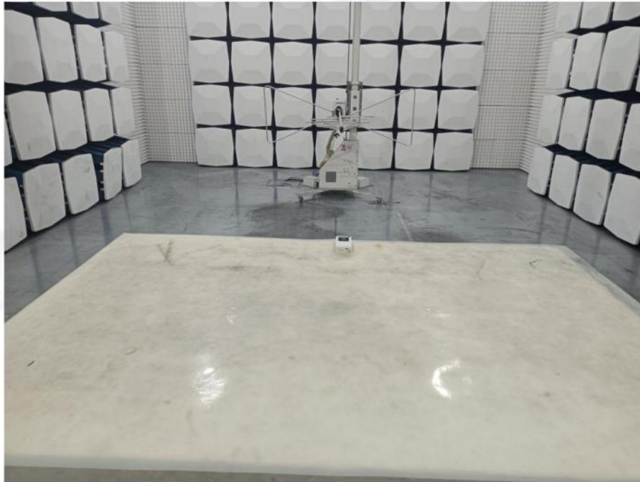
Konfiguracja testu emisji promieniowania 1 30 MHz – 1 GHz (Testy nadajników)
