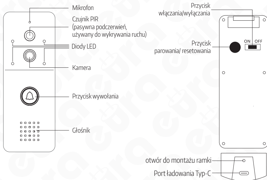
Rys. 3. Budowa kasety zewnętrznej
