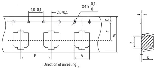
$E = 1,75 \pm 0,1 \text{ mm}$ ;  $t = 0,4 \pm 0,1 \text{ mm}$
