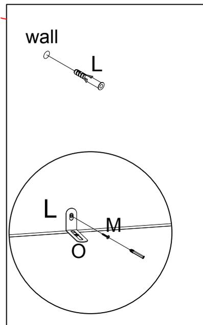
**DE:ACHTUNG:** Zur Sicherheit und Stabilität empfehlen wir Ihnen, die Kippsicherungszubehör an der Wand zu befestigen, um ein Umkippen, Verletzungen und Sachschäden zu verhindern.
