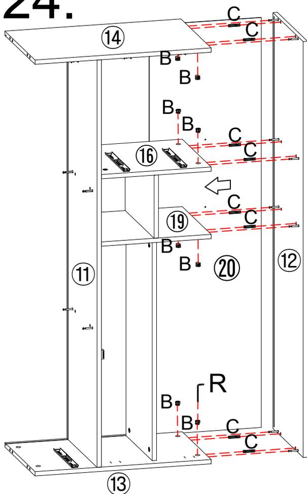
DE:Nach dem Platzieren der Rückwand ⑳ befindet sich das Loch oben genau auf der Komponente ⑯ und ⑰.
