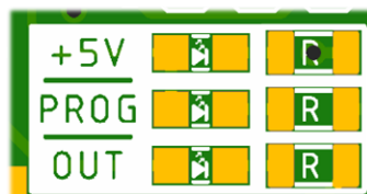
Zdj. 6 Sygnalizacja LED
