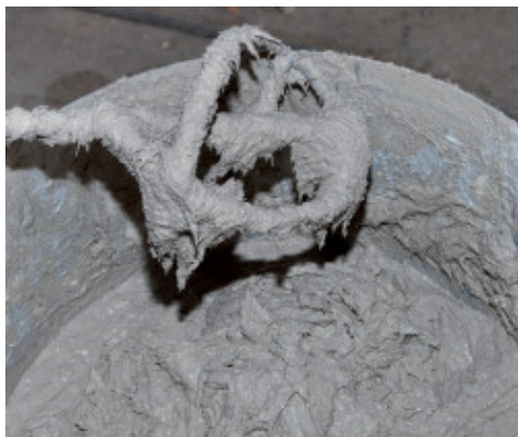
Zaprawa Planitop HDM Restauro tuż po wymieszaniu
