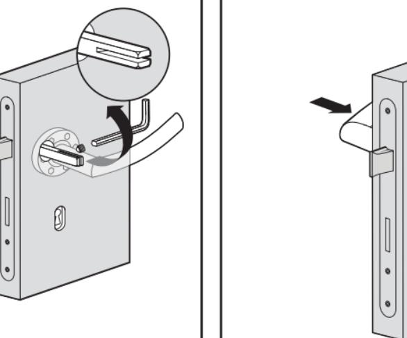
**PL:** W zależności od konstrukcji klamki i kierunku nacięcia w trzpień zamontowanym uprzednio w zamku należy mocno dokręcić śrubę imbusową od dołu lub boku klamki.
