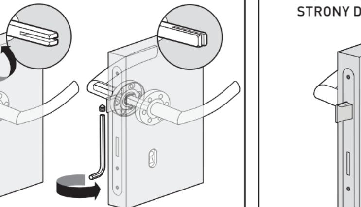
**PL:** W zależności od konstrukcji klamki i kierunku nacięcia w trzpieniu zamontowanym uprzednio w zamku należy mocno dokręcić śrubę imbusową od dołu lub boku klamki.
