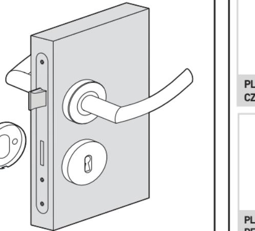
**PL:** Zamontować szyld dolny za pomocą elementów montażowych w zestawie i wcisnąć rozetę maskującą.
