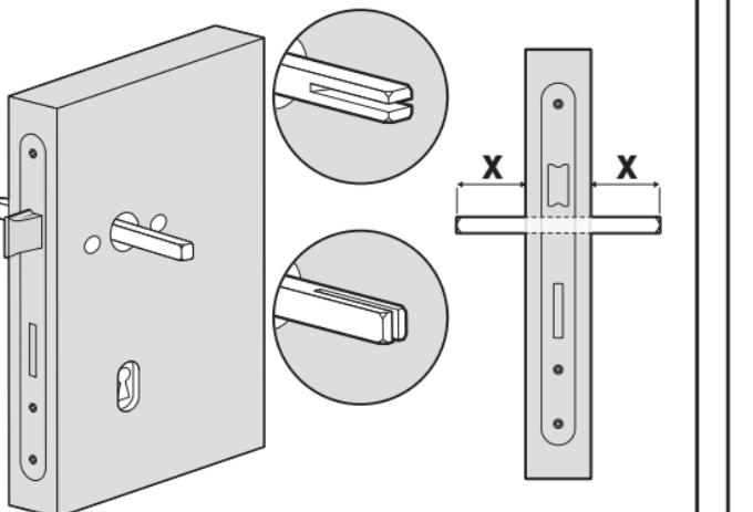
**PL:** Wsunąć trzpień symetrycznie do zamka zamontowanego w drzwiach, ustawiając nacięciem w odpowiednim kierunku w zależności od konstrukcji zastosowanej klamki.
