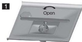
Krok 1: odkręcić filtr w kierunku pokazanym na rysunku.
