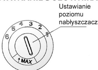
Dozownik nabłyszczacza ma sześć ustawienia. Zalecamy zawsze rozpoczęcie od ustawienia „4”. Jeśli powstają zacieki i występuje problem z suszeniem należy zwiększyć ilość uwalnianego nabłyszczacza, otwierając pokrywę nabłyszczacza i przekręcając tarczę na poziom „5”. Jeśli w dalszym ciągu występują problemy, należy zwiększać dozowanie o kolejny stopień, aż naczynia będą bez zacieków i suche. Fabrycznie dozownik jest ustawiony na „4”.
