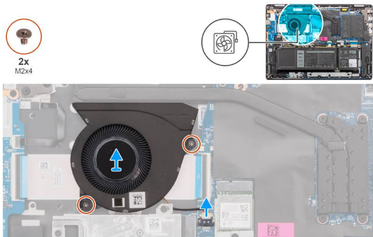
Rysunek 26. Wymontowywanie wentylatora
