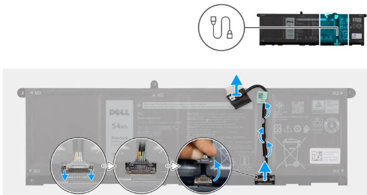
Rysunek 29. Odlaczanie kabla baterii
