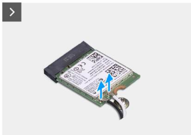
Rysunek 22. Wymontowywanie karty sieci bezprzewodowej
