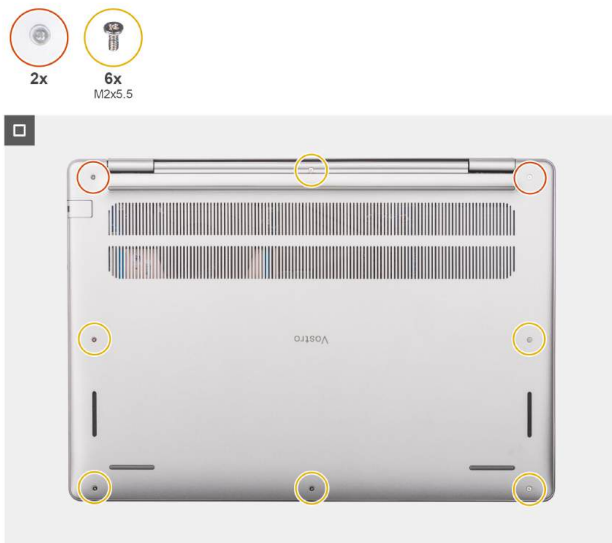
Rysunek 17. Instalowanie pokrywy dolnej
