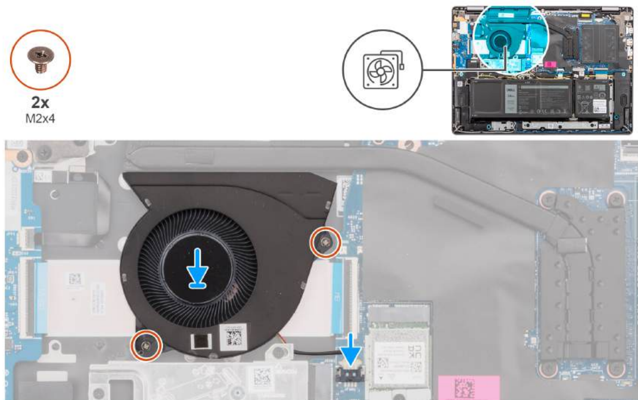
Rysunek 27. Instalowanie wentylatora
