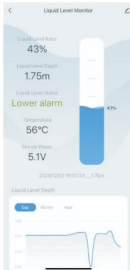
Alarm niskiego poziomu
