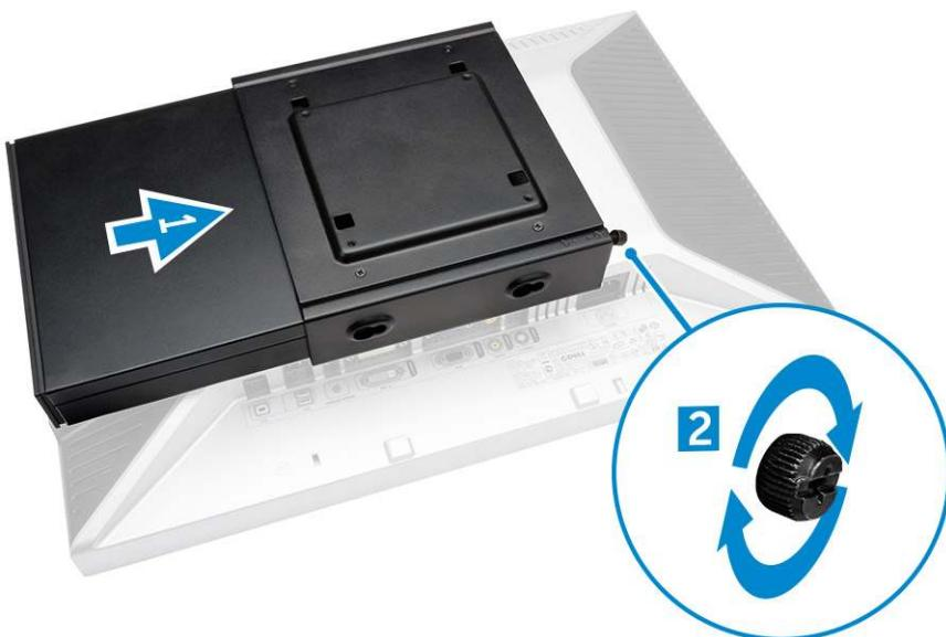
3. Schieben Sie das Netzadaptergehäuse durch die Aussparungen im unteren Bereich der VESA-Doppelhalterung, bis es einrastet.
