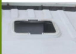
Zdemontuj i oczyść świetlik
