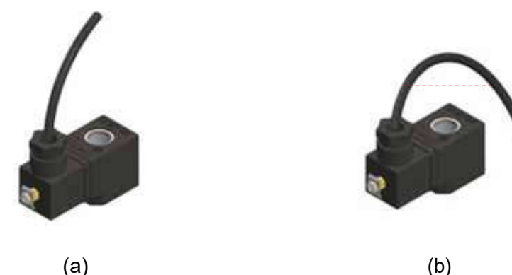
Rysunek 17. Ułożenie kabla połączeniowego: (a) prawidłowe (b) nieprawidłowe
