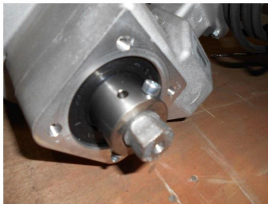
4. Przykręcić nakrętkę oraz założyć z powrotem osłonkę
