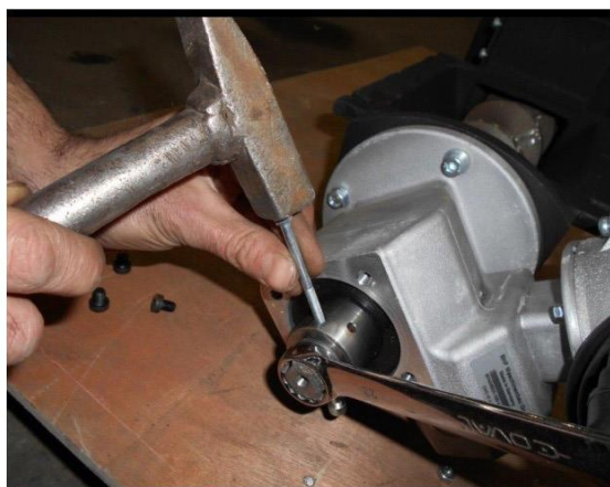
3. Wybić starą śrubę zawleczką dołączoną do zestawu (śruba m5 twardość 8.8)
