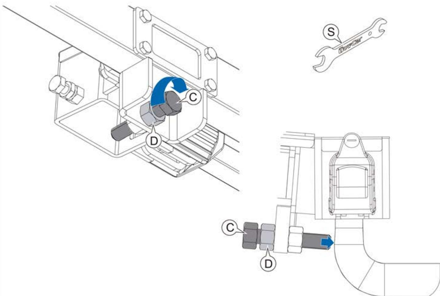
**ES** Ajuste del sistema antibalanceo: Afloje la contratuerca (D) y gire el tornillo (C) hasta que haga contacto con el cuello de la bola del enganche. Vuelva a apretar la contratuerca (D). Esta operación se realizará solo la primera vez que coloquemos nuestro portamotos en el vehículo o si lo colocamos sobre un vehículo diferente al nuestro.
