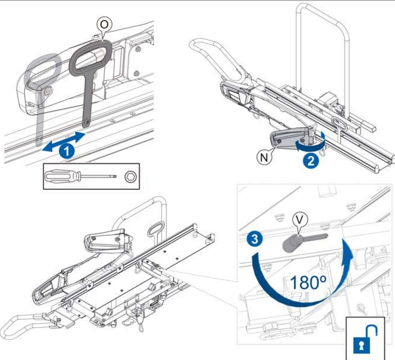
**ES** Regular la posición de la maneta (O) dentro de la guía para que la operación de carga y descarga de la moto sea lo más cómoda posible para el usuario. Aflojar el tornillo de fijación con una llave allen, deslizar en la guía y volver a apretar el tornillo.
