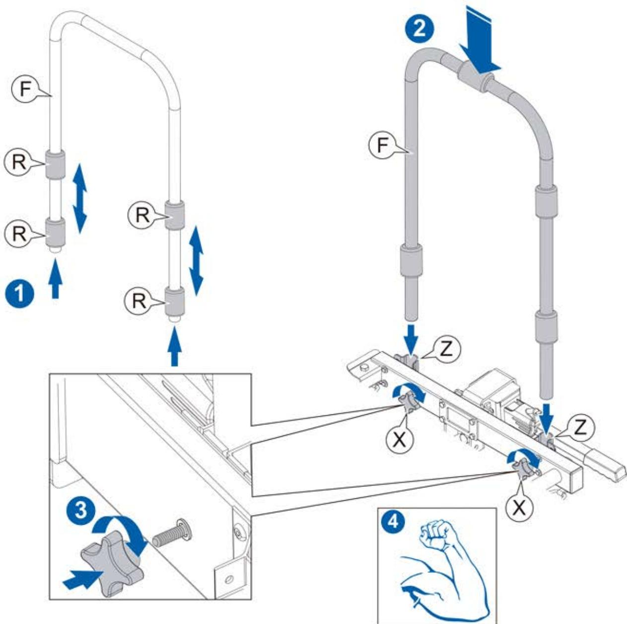
**ES** Deslizar los cuatro protectores de espuma (R) por la barra (F) y posicionarlos en aquellos puntos del carenado o cuerpo de la moto que puedan entrar en contacto con el tubo. Introducir el soporte en las abrazaderas (Z) y apretar con fuerza el volante (X). Verifique su correcta fijación.
