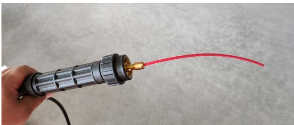
Rys. 9. Teflonowa osłona drutu aluminium w uchwycie spawalniczym MIG
