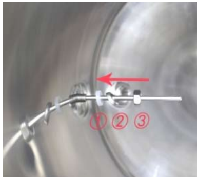
Upevnite diely v poradí (silikónový krúžok / plochá podložka / matica)
