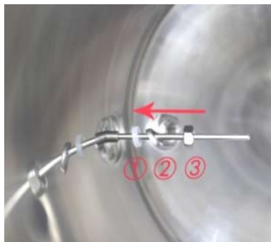
Pritrdite dele v zaporedju (silikonski obroč / ploščata podložka / matica)
