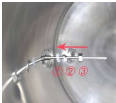
Pritvirtinkite dalis iš eilės (silikono žiedas / plokščia poveržlė / veržlė)
