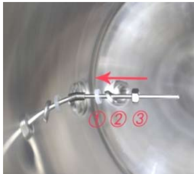
Upevněte díly v pořadí (silikonový kroužek / plochá podložka / matice)
