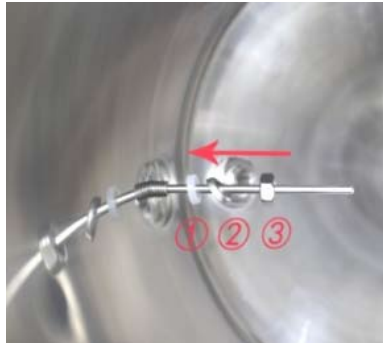
Fixa delarna i sekvens (silikonring / platt bricka / mutter)
