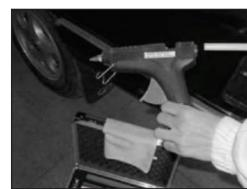
4. Leim auf die Unterseite des Pilzes (Adapter) auftragen und durch Drücken des Abzuges der Leimpistole dosieren. Kleben Sie den Pilz auf die Einbeulstelle.
