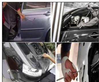
7. Rimuovere i residui di adesivo dal corpo spruzzandolo con un dispositivo di rimozione adesivo e quindi grattare delicatamente con un raschietto.
