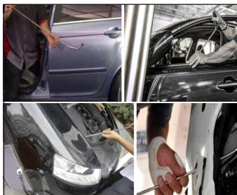
7. Elimine los restos de adhesivo de la carrocería rociando con un disolvente apropiado para finalmente retirar cuidadosamente con un rascador.
