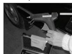
4. Aplique adhesivo en la parte inferior de la pastilla (adaptador) y dosifique presionando el gatillo de la pistola. Pegue la pastilla sobre el lugar en el que se encuentra la abolladura.
