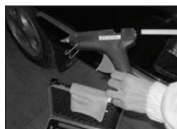
4. Naneste lepidlo na spodní část kontaktního klipu, lepidlo dávkujte stlačováním spouště pistole na lepidlo. Klip přilepte v místě promáčkliny.
