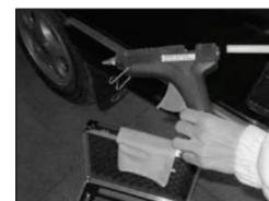
4. Nałożyć klej na spodnią część grzybka (adaptera), doując go poprzez ściskanie spustu pistoletu do kleju. Przykleić grzybek do miejsca wgniecenia.
