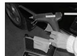
4. Applica la colla sul lato inferiore del fungo (adattatore) e dosa premendo il grilletto della pistola. Incolla il fungo sul posto dell'ammaccatura.
