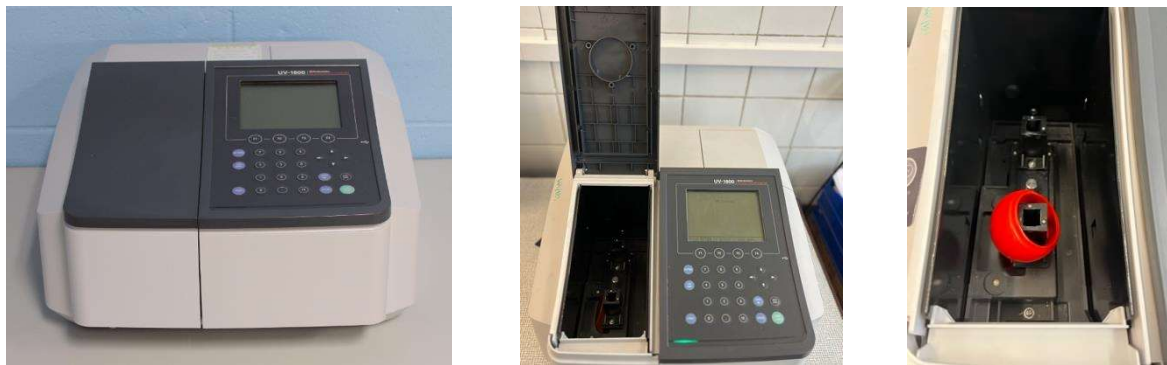
Rys.3. Zastosowany spektrofotometr UV-Vis wraz z próbka
