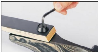
2. Bevestig de bovenste ledemaat aan het bovenste uiteinde van de riser, plaats de positioneringspennen, draai dan de bout van de ledemaat vast, hetzelfde procedure voor de onderste ledematen.
