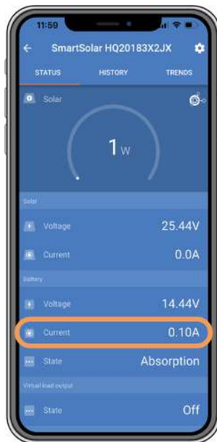
Aplikacja VictronConnect pokazuje prąd ładowania bliski zeru.
