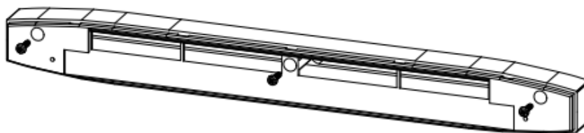
Rys. 2. Przykręcenie łącznika akustycznego RA
