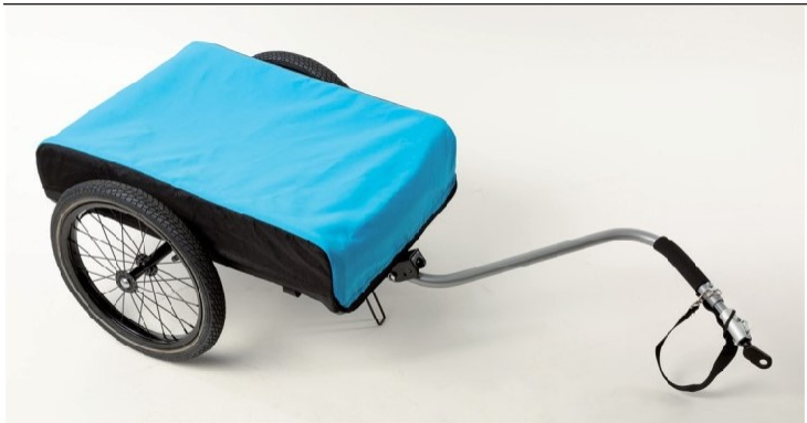
Zmontowana przyczepa z wykładziną i peleryną
