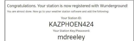
Bemærk: Dit stations-ID vil have formen: KSSCCCC###, hvor K står for USA-station (I for international), SS er din stat, CCCC er din by, og ### er stationsnummeret i den pågældende by.
