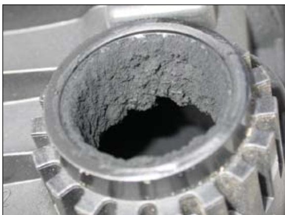
Zablokowany kolektor dolotowy
