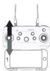
Wychylenie lewego drążka w górę i w dół kontroluje podnoszenie i opadanie drona.
