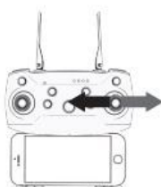
Wychylenie prawego drążka w lewo lub w prawo kontroluje poruszanie się drona na boki.
