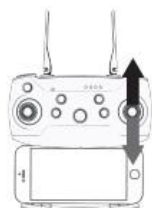
Wychylenie prawego drążka w górę lub w dół kontroluje poruszanie się drona w przód lub w tył.
