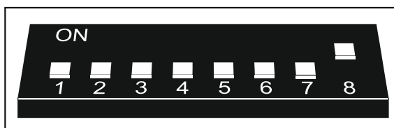
Rys. 13. Sposób ustawienia przełączników DIP-switch w kontrolerze ACU-120 / ACU-270.
