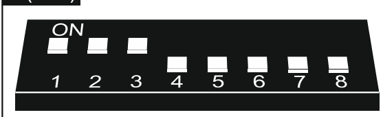
Rys. 9. Sposób ustawienia adresu w ekspanderze INT-RX-S / INT-RX.
