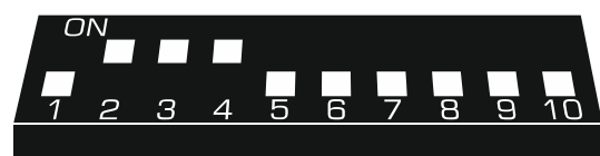
Rys. 16. Sposób ustawienia przełączników DIP-switch w ekspanderach, jeśli mają one zostać zidentyfikowane jako CA-64 Ei / CA-64 EPSi.
