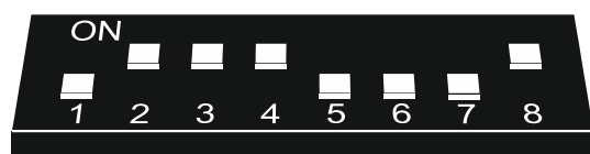
Rys. 16. Sposób ustawienia przełączników DIP-switch w ekspanderach, jeśli mają one zostać zidentyfikowane jako CA-64 Ei / CA-64 EPSi.
