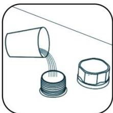
**②. OUVREZ L'ENTRÉE D'ALIMENTATION EN EAU POUR FOURNIR DE L'EAU DE REFROIDISSEMENT (NE PAS DÉVERSER L'EAU !).**
