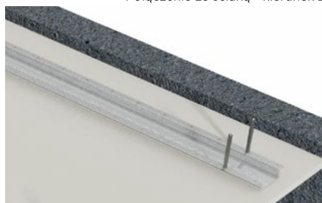
Połączenie ze ścianą - kierunek 2
