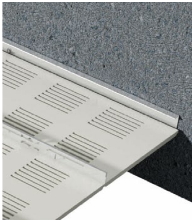
Połączenie ze ścianą - kierunek 2
