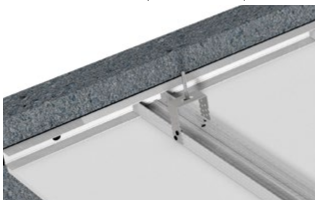
Połączenie ze ścianą - kierunek 1
