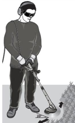
Učinkovito košnje trave s uređajem moguće je samo ako trava nije viša od 15 cm. Držite trimer podalje od tvrdih predmeta. Kad je linija ili oštrica dođe u dodir s tvrdim predmetom, kabel može puknuti ili se ošteti odnosno oštrice. Kamenje se može odbaciti i velikom brzinom pogoditi okolne objekte, uzrokujući štetu. Zabranjeno je koristiti uređaj bez sigurnosnog poklopca.
