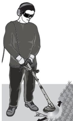
Efektivní sekání trávy se zařízením je možné pouze na trávě nepřesahující 15 cm. Udržujte sekačku mimo dosah tvrdých předmětů. Pokud se struna nebo nůž dostane do kontaktu s tvrdým předmětem, může se struna nebo nůž zlomit nebo poškodit. Kamenné mohou být vymrštěny a zasáhnout blízké předměty vysokou rychlostí a způsobit poškození. Je zakázáno používat zařízení bez bezpečnostního krytu.
