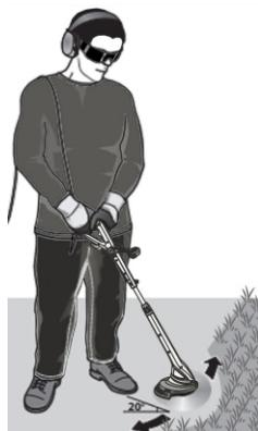
Tráva sa dá efektívne kosiť vtedy, keď má výšku aspoň 15 cm. Krovinorez nepribližujte k tvrdým predmetov. V prípade, keď dojde ku kontaktu struny alebo čepele s tvrdým predmetom, struna alebo čepeľ sa môžu poškodiť. Kamene môžu byť vymrštené s vysokou rýchlosťou a udrieť s veľkou silou do predmetov v okolí, následkom čoho sa môžu poškodiť. Zariadenia v žiadnom prípade nepoužívajte bez bezpečnostného krytu.
