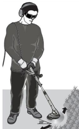
Tunderea eficientă a ierbii cu ajutorul dispozitivului este posibilă numai în cazul în care iarba nu depășește lungimea de 15 cm. Nu apropiați trimmer-ul de obiecte dure. În cazul în care firul sau lama intră în contact cu un obiect dur, firul se poate rupe, iar firul sau lama se pot deteriora. Pietrele pot fi aruncate și pot lovi obiectele din jur cu o viteză mare, provocând pagube. Este interzisă utilizarea dispozitivului fără apărătoarea de siguranță.
