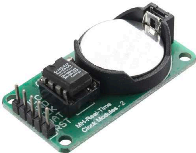
Moduł zegara czasu rzeczywistego RTC DS1302
