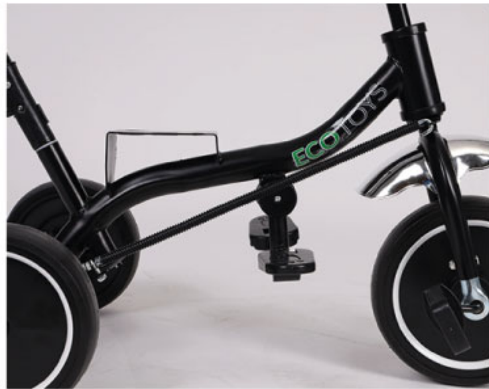
10. Prawidłowo zamontowana linka do kierowania
