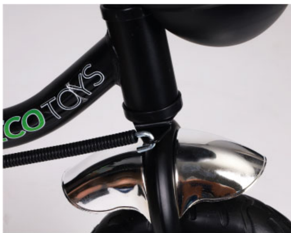
8. Zamontuj linkę do kierowania
