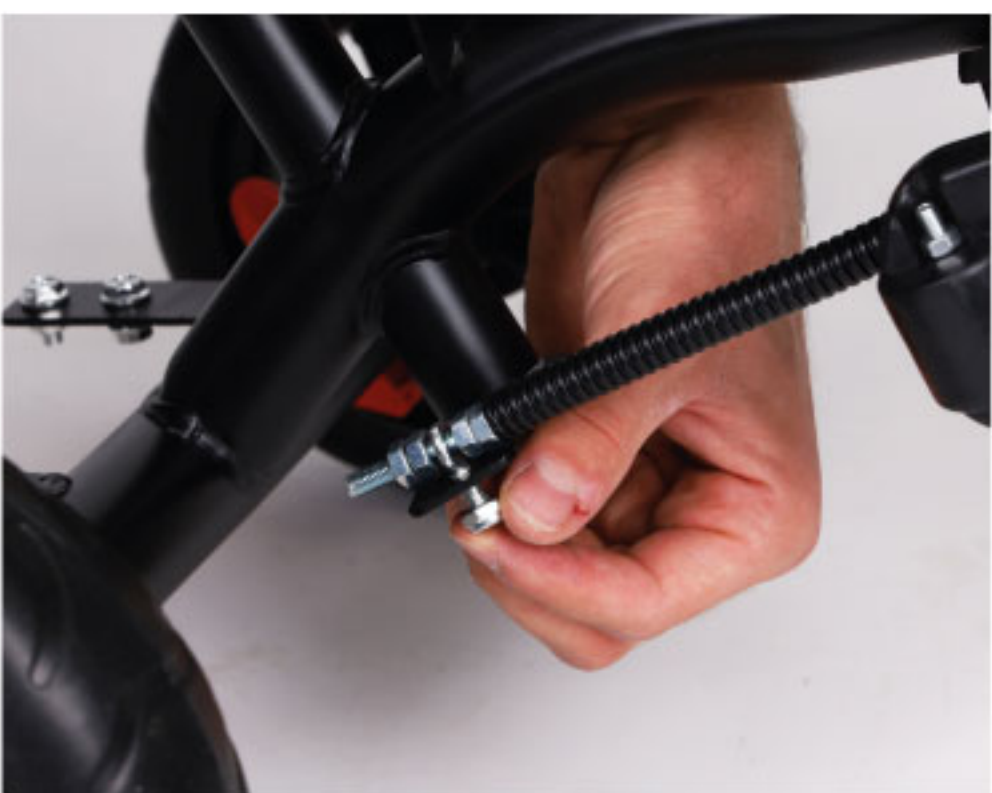
9. Linkę do kierowania zamocuj śrubami
