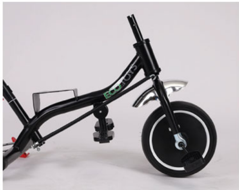
1. Zamontuj przednie koło
