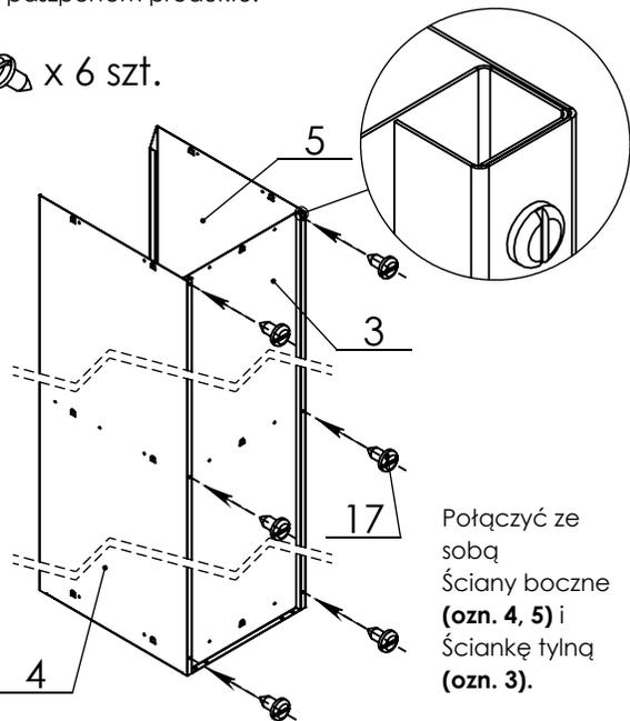
Połączyć ze sobą Ściany boczne (ozn. 4, 5) i Ściankę tylną (ozn. 3).
