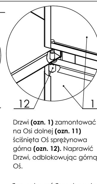
Drzwi (ozn. 1) zamontować na Osi dolnej (ozn. 11) ściśniętą Oś sprężynowa górna (ozn. 12). Naprawić Drzwi, odblokowując górną Oś.
