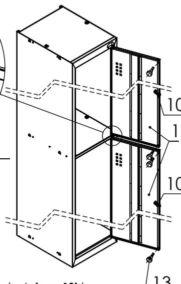
Zamontować Zamek na drzwiach (ozn. 10) i naprawić za pomocą nakrętki na zamku. Zamontować amortyzatory w odpowiednich otworach na drzwiach (ozn. 13) (2 szt. na 1 skrzydło drzwi).
