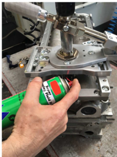
Zdjęcie 30. Smarowanie spirali wiertła
