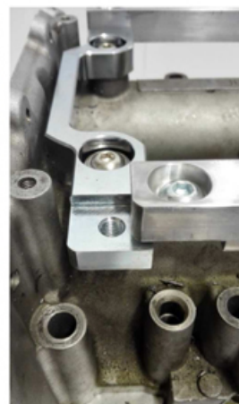
Zdjęcie 13. Mocowanie przedniej listwy (jedna z dwóch listw nr 3) i dokompletowanie ramy oporowej do montażu mechanizmu wierzącego
