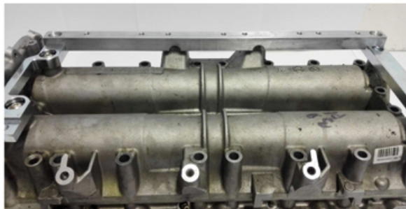
Zdjęcie 12. Ułożenie tylnej listwy nr 3 na już zamontowane listwy nr 1 i 2.
