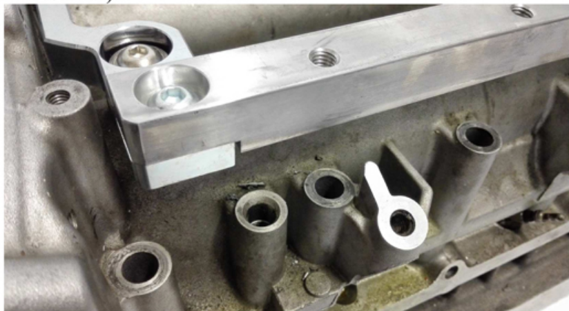
Zdjęcie 13. Mocowanie przedniej listwy (jedna z dwóch listw nr 3) i dokompletowanie ramy oporowej do montażu mechanizmu wierzącego
