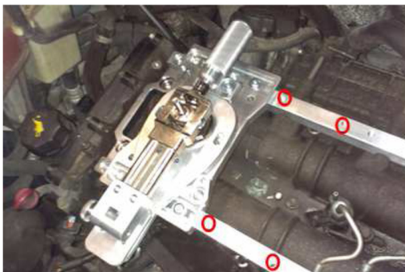
Zdjęcie 36. Przesuwanie mechanizmu wierzącego na kolejne pozycje
