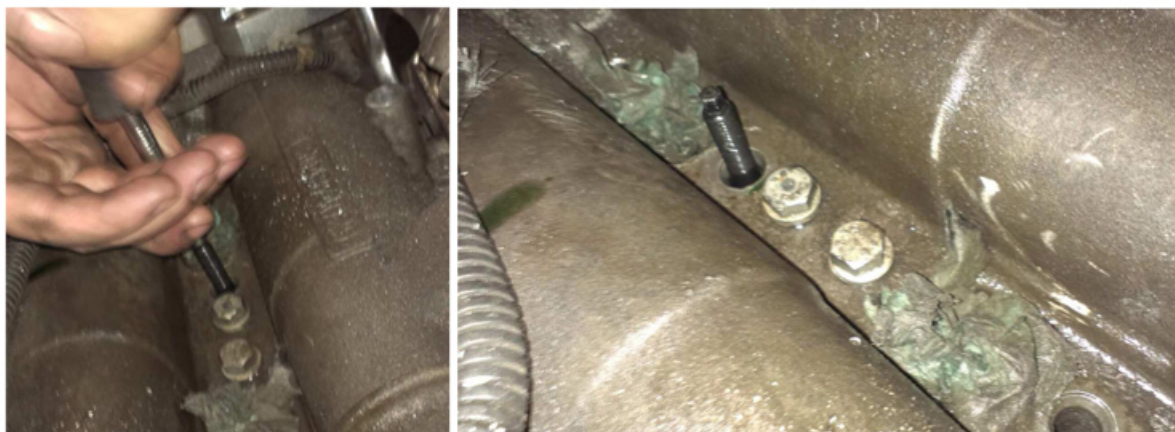
Zdjęcie 35. Dokręcenie adaptera można wykonać kluczem z grzechotką i nasadką.
