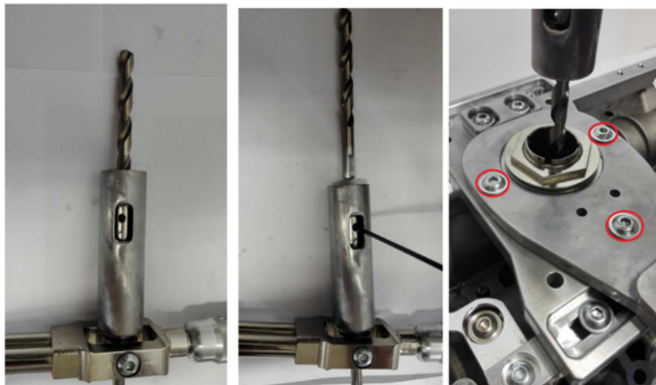
Zdjęcie 25. Montaż odpowiednio wybranego wiertła i dokręcenie 3 śrub środka mechanizmu wierzącego
