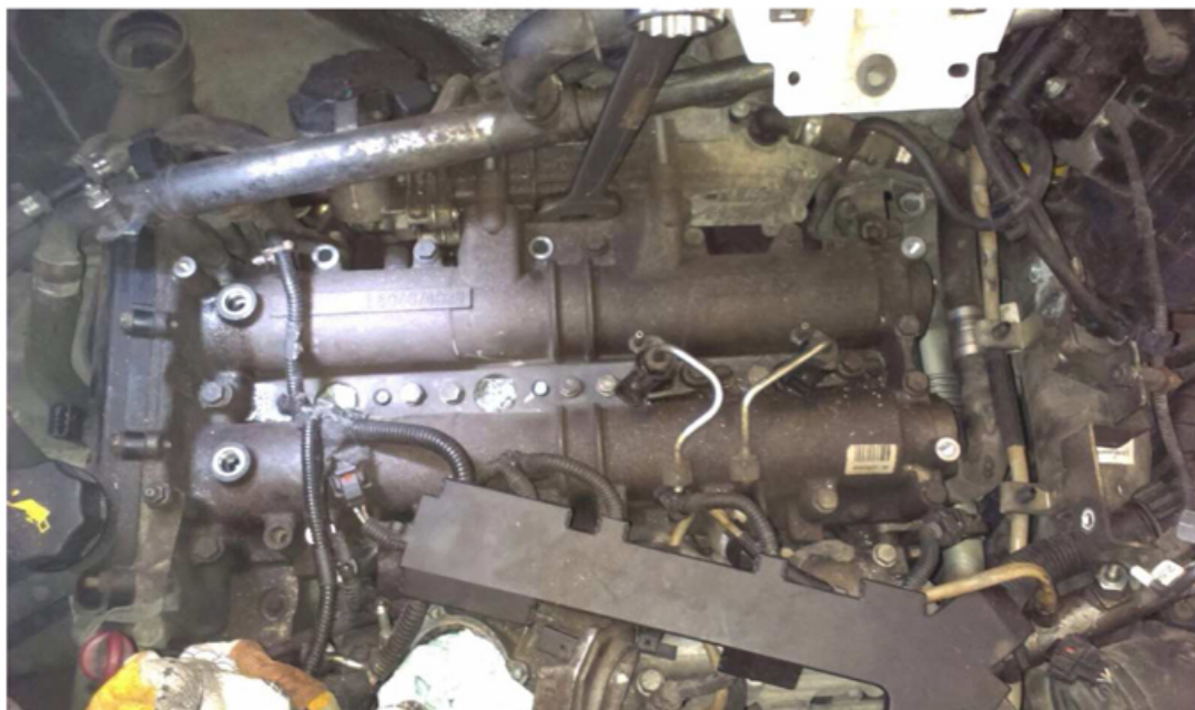
Zdjęcie 7. Przed założeniem przyrządu wierzącego konieczne jest zdemonowanie niektórych elementów silnika, takich jak przewody paliwowe, przewody elektryczne, przewody powietrzne itp.
