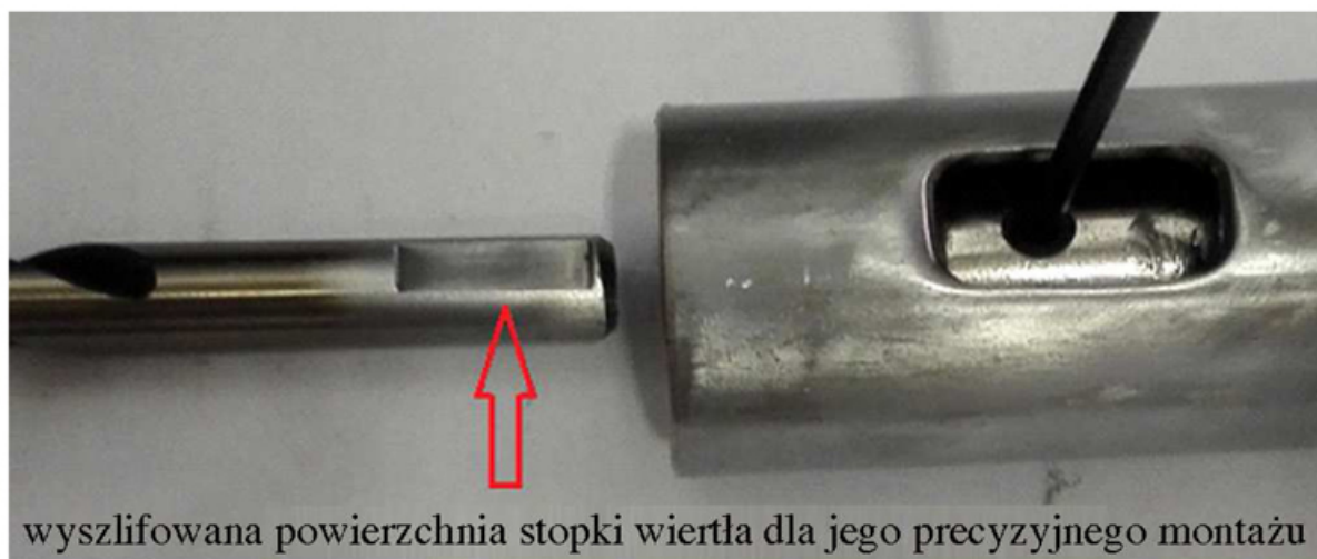
Zdjęcie 24. Ułożenie wiertła do otworu przedłużenia mechanizmu wiercącego
