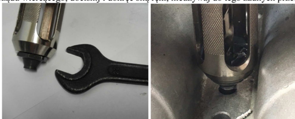
Zdjęcie 21. Montaż końcówki wierzącej nr 5 przy użyciu klucza nr 15 + szczegółowe założenie tulei wierzącej na zerwaną śrubę.
