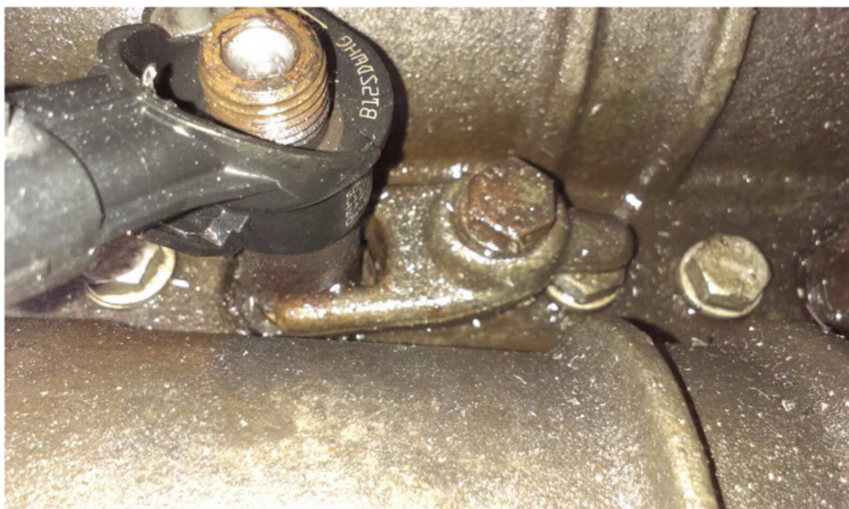
Zdjęcie 6. Kawałek śruby M8x1, do mocowania wtryskiwacza
