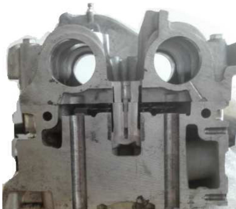
Zdjęcie 33 . Przekrój głowicy cylindra silnika Fiat Ducato HPi 3.0l
