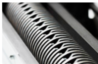
Hartowane wałki tnące umożliwiają precyzyjne cięcie materiału
