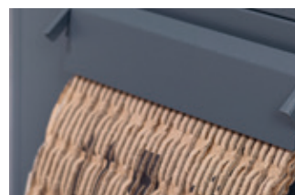
2-warstwowy materiał wypełniający otrzymany po zamknięciu klapki kompresującej (HSM ProfiPack P425).
