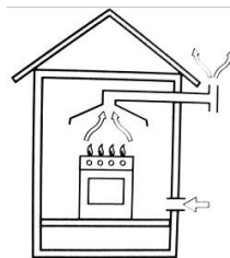
Wylot bezpośrednio na zewnątrz.
