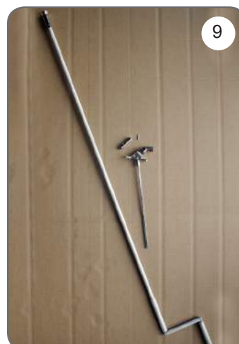
Korba, przegub Cardana 45° lub 90° z zaczepem dzwonicowym [9].
