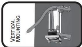
Se till att skäraren är monterad på en solid vägg och använd lämplig bult (köp separat) för att fixa den
