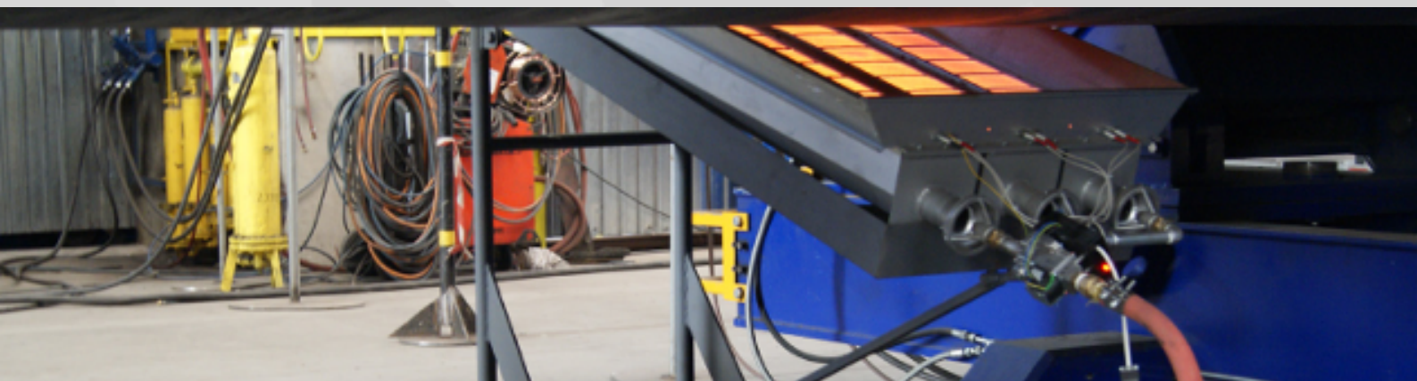
Promiennik do podgrzewania materiału przed spawaniem
