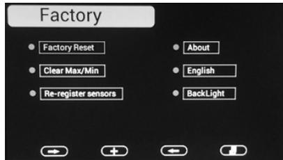
Pour restaurer les paramètres d'usine, faites défiler jusqu'au champ Factory Reset et appuyez sur le bouton **+**, pour effacer tous les paramètres.
