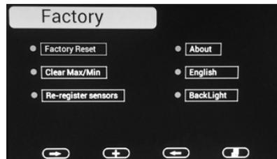
Para restaurar la configuración de fábrica, desplácese (←) hasta el campo Restablecer valores de fábrica y presione el botón (+), para borrar todas las configuraciones.
