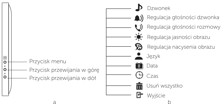
Rys. 5. Rozmieszczenie przycisków regulacyjnych na boku monitora oraz drzewko Menu
