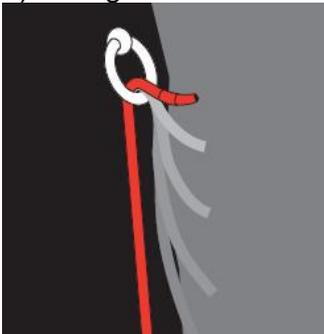
La cuerda que se recoge debe tenderse **en** el lado del acantilado del punto de anclaje para evitar atrapar el extremo de la cuerda entre el anillo y la pared de la roca.
