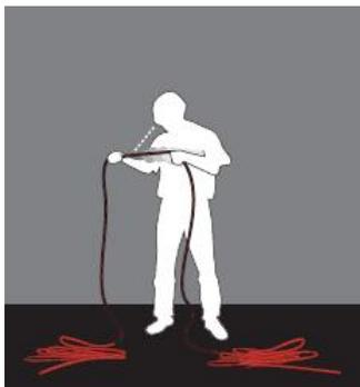
Po każdym użyciu należy dokładnie sprawdzić linę. Aby to zrobić, przeciągnij linę przez dłonie metr po metrze, sprawdzając wybrzuszenia, twarde miejsca i inne nierówności oraz szukając widocznych uszkodzeń oplotu. Jeżeli na oplotce znajdują się istotne nieprawidłowości fizyczne, cienkie lub otwarte obszary lub inne oznaki uszkodzenia, należy wymienić linę.
