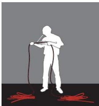
Efter varje användning bör du noggrant undersöka ditt rep. För att göra detta, kör repet genom händerna meter för meter och känn efter utbuktningar, hårda fläckar och andra ojämnheter och leta efter uppenbara skador på slidan . Om det finns betydande fysiska ojämnheter, tunna eller öppna områden på höljet, eller andra tecken på skada , ska repet bytas ut. Repet bör inte utsättas för vätskor, fasta ämnen, gaser, dimma eller några ämnen som syror, baser och lösningsmedel som kan förstöra repet.
