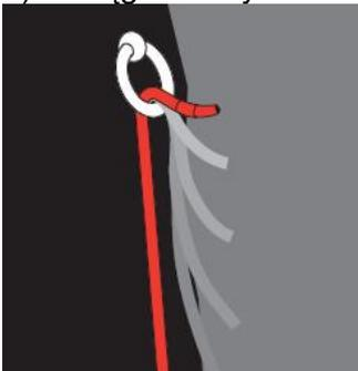
Wciągając linę należy ułożyć **od** strony klifu w punkcie kotwiczenia, aby uniknąć przytrzaśnięcia końca liny pomiędzy pierścieniem a ścianą skalną.
