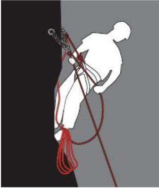
En entornos como cascadas, escaladas alpinas y condiciones de viento, es crucial asegurarse de que las bobinas de cuerda no cuelguen por debajo de la posición de aseguramiento.
