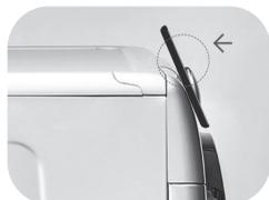
Dacă nu cunoști poziția antenei NFC, mișca circular încet telefonul deasupra logo-ului Smart Touch până când Aplicația confirmă conexiunea. Pentru ca transferul de date să se realizeze cu succes este esențial SA TII TELEFONUL PE MAȘINA ÎN CELE CĂTEVA SECUNDE ALE PROCEDURII; un mesaj pe dispozitiv te va informa cu privire la rezultatul corect al operațiunii și îți va recomanda îndepărtarea telefonului.
