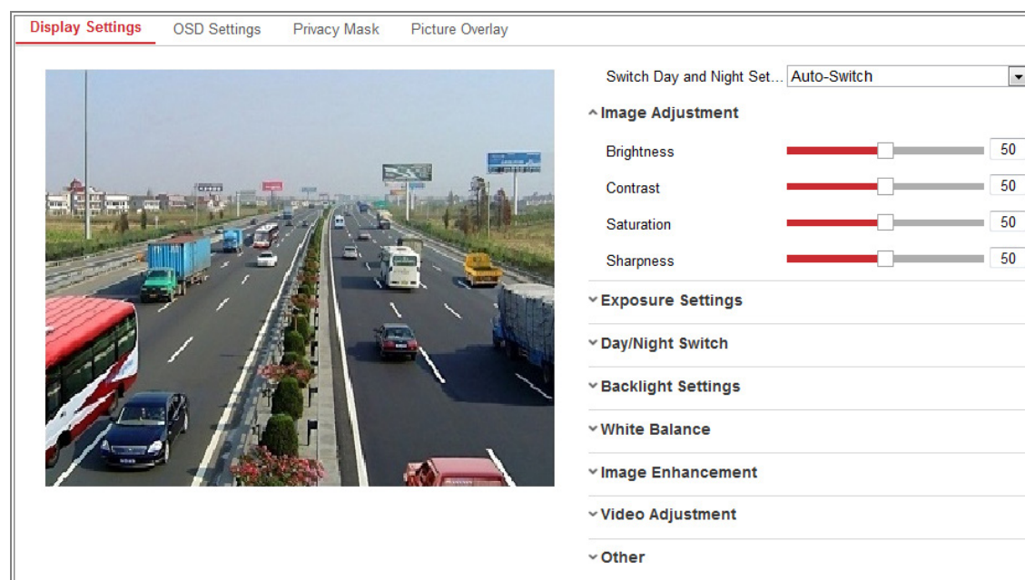
Rysunek 9–1 Ustawienia wyświetlania automatycznego przełącznika trybu dzień/noc
