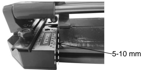
Tipps: Legen Sie die Fliese nicht zu weit nach innen, um sicherzustellen, dass die Ritzlinie ein Ganzes ist Linie, nach dem Einritzen ist es besser, den Griff zurückzuziehen, um den Brecher Gehen Sie leicht 5–10 mm zurück. Dies ist die beste Position zum Brechen der Fliese.
