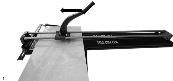
Umieść kółko tnące na tylnej krawędzi płytki.
