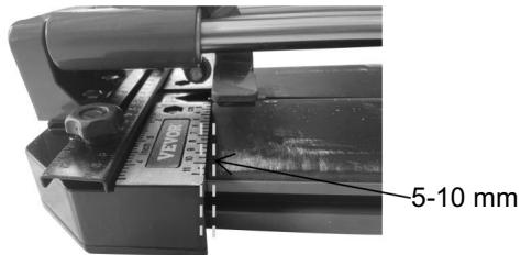
Consejos: No coloque la ficha demasiado adentro para asegurarse de que la línea de puntuación sea completa. Línea, después de marcar, es mejor tirar hacia atrás el mango para dejar que el interruptor retroceda ligeramente entre 5 y 10 mm, es la mejor posición para romper la baldosa.
