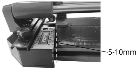
Wskazówka: Nie umieszczaj płytki zbyt głęboko, aby linia rowka była cała linia, po nacięciu, lepiej odciągnąć uchwyt, aby umożliwić wyłącznik cofnij się lekko o 5-10 mm, to najlepsza pozycja do złamania płytki.
