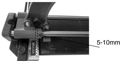
Tips: Na het scoren is het beter om de hendel terug te trekken om de breker iets terugtrekken 5-10mm, wat de beste positie is om breekt de tegel.
