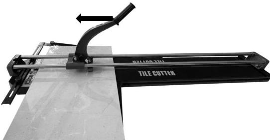
Setzen Sie das Schneidrad an der Hinterkante der Fliese an.
