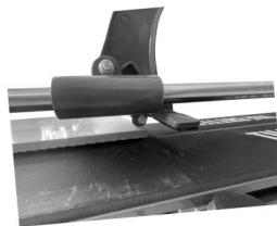
Setzen Sie das Schneidrad an der hinteren Kante der Fliese an.
