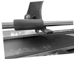
Umieść kółko tnące na tylnej krawędzi płytki.
