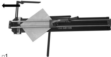
Coloque la baldosa en la máquina contra la regla de ángulo ajustada.
