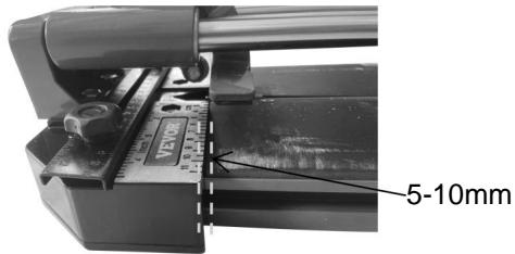
Tips: Plaats de tegel niet te ver naar binnen, zodat de snijlijn een geheel vormt lijn, na het scoren is het beter om de hendel terug te trekken om de breker te laten Trek de tegel iets terug, 5-10 mm. Dit is de beste positie om de tegel te breken.
