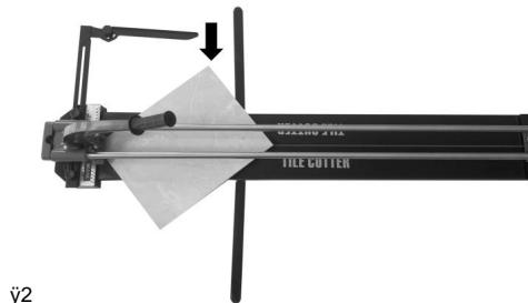
Nach dem Einritzen und ohne die Position der Fliese zu verschieben, ist der Brecher leicht in der Fliesenvorderkante und dem Frontanschlag.
