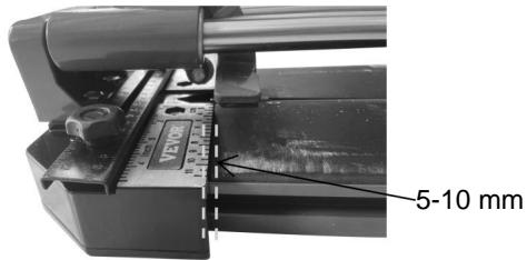
Tips: Lägg inte brickan för inuti för att se till att poänglinjen är en hel linje, efter poäng, är det bättre att dra tillbaka handtaget för att låta brytaren något backtrack 5-10mm, det är den bästa positionen för att bryta brickan.
