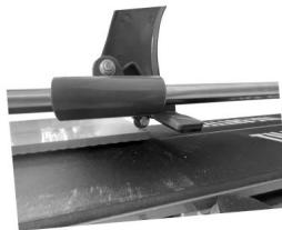
Coloque la rueda de corte en el borde trasero de la baldosa.
