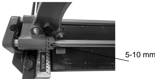
Tipps: Nach dem Einritzen ist es besser, den Griff zurückzuziehen, um die Unterbrecher wird 5-10 mm leicht zurückgezogen, was die beste Position ist, um zerbrich die Fliese.
