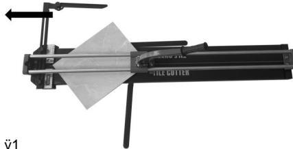
Legen Sie die Fliese gegen das eingestellte Winkellineal auf die Maschine.
