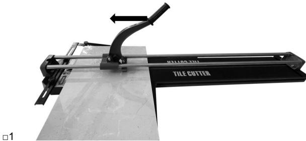
Coloque la rueda de corte en el borde trasero de la baldosa.
