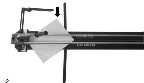
Después de marcar y sin mover la posición de la ficha, el breaker está ligeramente en el borde frontal de la baldosa y el tope delantero.
