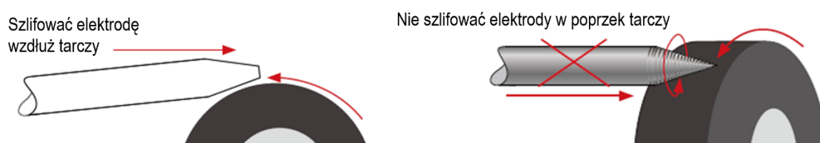
Rys. 16. Szlifowanie elektrody wolframowej
