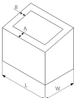
Wskazanie stref zwiększych sił ssawnych wiatru określa się na podstawie podstawowych wymiarów budynku (rys.1), gdzie:
