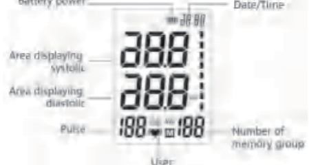
Abbildung 4. Skizze des LCD-Bildschirms
