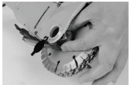
6. Entfernen Sie den Abstandshalter zwischen der Säge Klingen
