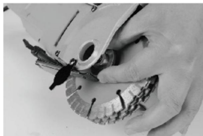
6. Verwijder de afstandhouder tussen de zaag messen
